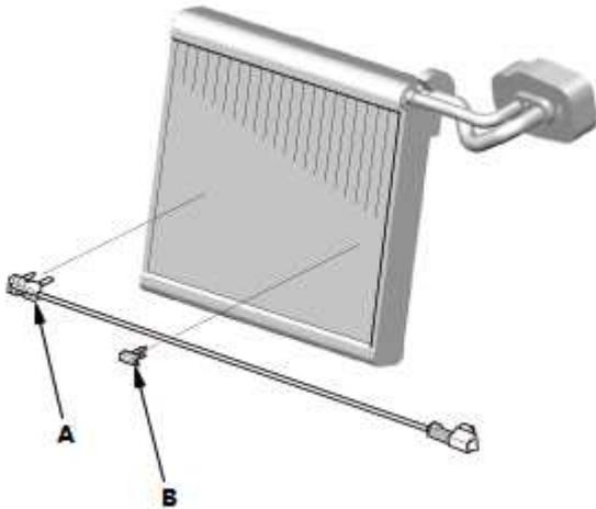
1. 拆下蒸发器温度传感器 (A) 和卡扣 (B)。
